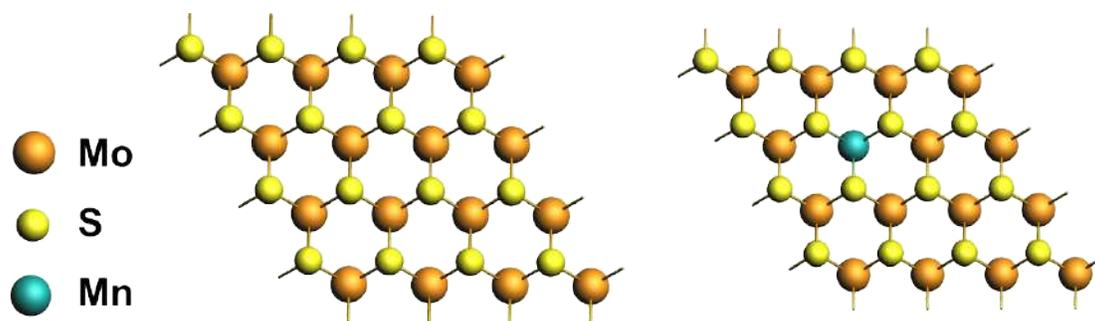
Figura 3. Superceldas de MoS<sub>2</sub>. Catalizadores de la reacción de evolución de hidrógeno.
